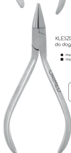
KLESZCZE ORTODONTYCZNE ANGLE do doginiania drutu i formowania pętli Angle pliers ● max 0.36 mm do 0.71 mm (.014" do .028") ■ max 0.56 mm x 0.71 mm (.022" do .028")
